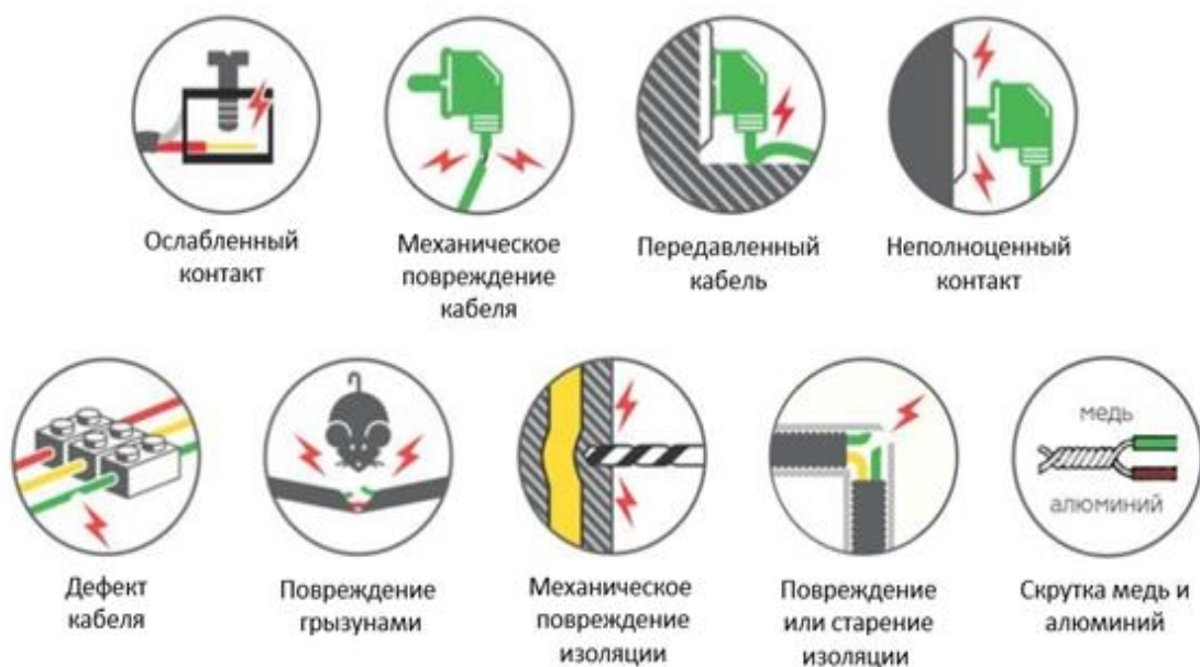
Рисунок 6. Возможные причины искрения в электропроводке
